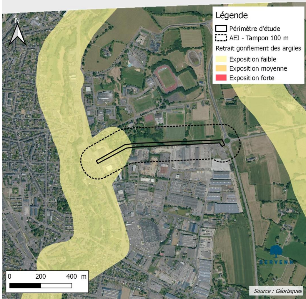
Figure 6 : Secteurs soumis à l'aléa retrait-gonflement des argiles
